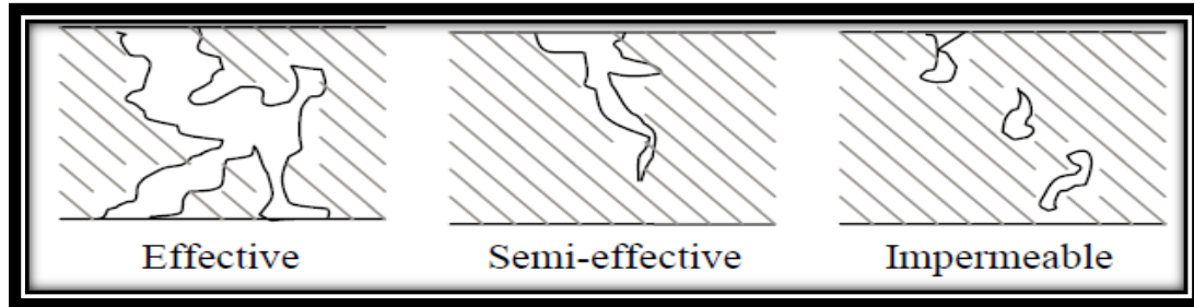
Figure 2.6: Air Void Forms in pavement. (Kassem, 2011.)
